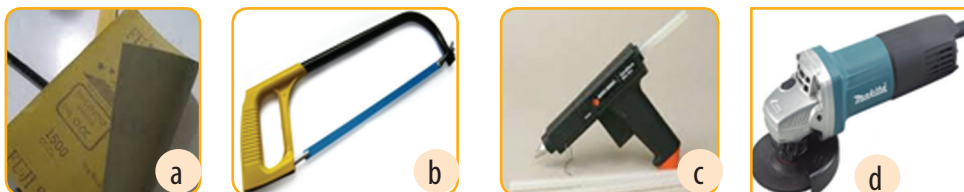
Sumber: Dok. Kemdikbud Gambar 1.17. Alat pembuatan kerajinan limbah tulang ikan: a. amplas, b. gergaji, c. lem tembak, dan d. gerinda
