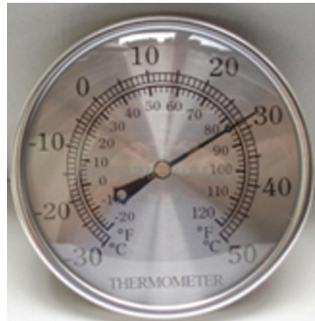
Sumber: www.diytrade.com Gambar 4.7 Termometer bimetal, digunakan untuk pengukur suhu
